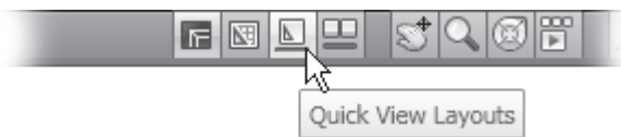
وينه ي 7-13: نامرازى بىنننى خىزاي له يئاوته كان Quick View Layouts له ناو شريتي دؤخ Status bar دا.
