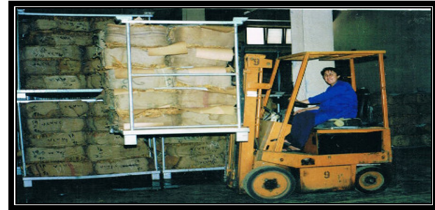
وینەي(۲۳-۳) رافعی شەوکی بۇ گواستنەوہی بالەي توتنەکان لەناو کۆگای توتنی ترشینراودا
