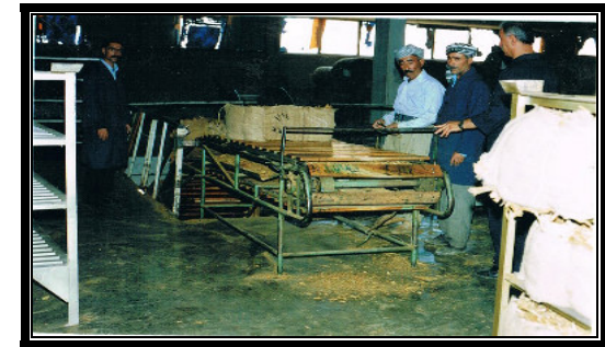
وینەي (۱-۱۸) پشتینەيەکی گوێزەرەو بۆ گواستنەوہي تووتن لە کارگەي
