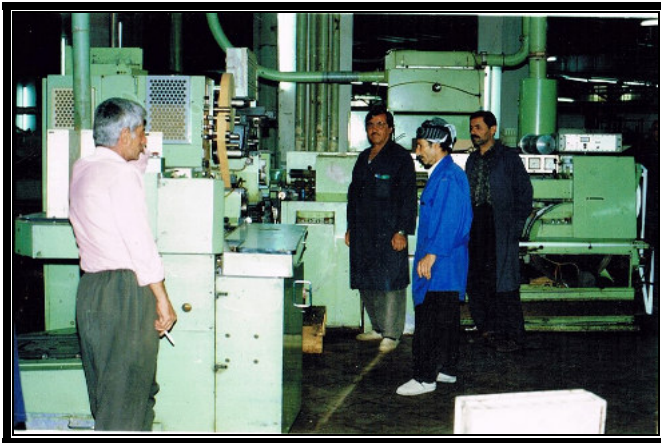
وینەي (۲۵-۳) مەکینەيەکی دروستکردنی جگەرە بە توانای ۴۰۰۰ جگەرە/ خولەك بۆ ھەر مەکینەيەك
