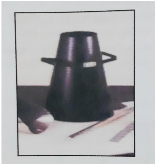
شىوہى(7-2) قالبى تاقىكردنەوہى دابەزىن و شىشى رۆيشتن
