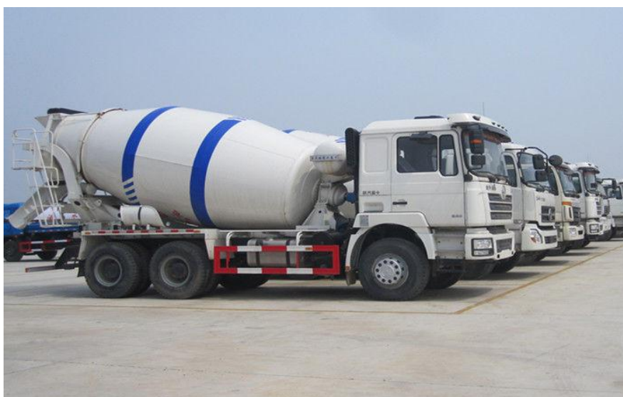
شېۋەى(2-4) فۇتۇمبىلى تېكەلكەرى كۆنكرېت تواناى 10 مەترسىجايى
