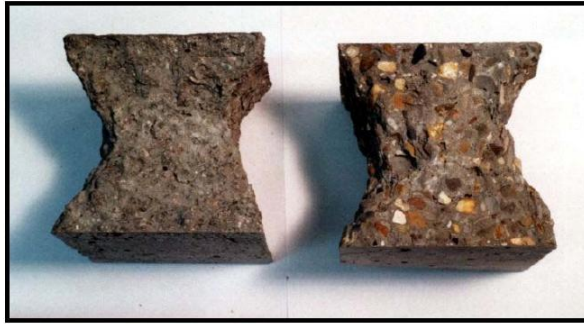
شىۋەي(8-19) شكاندى نمونە شەشپالوئەكان لە تاقىكدنەوەى بەرگرى فشاردا
