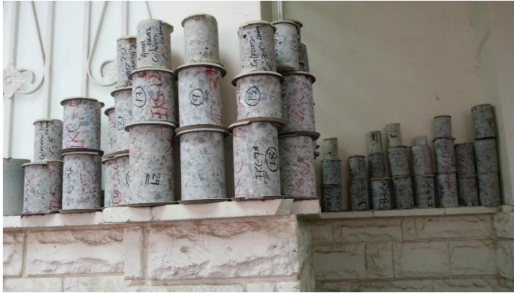
شىۋەى(9-17) كۆمەلىك لەدى كۆنكرېتى دەرهاتوو(Core)
