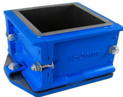
شىوھى(8-13) قالبى شەشپالووى كانزايى شىوھى(8-14) قالبى شەشپالووى پلاستېكى
