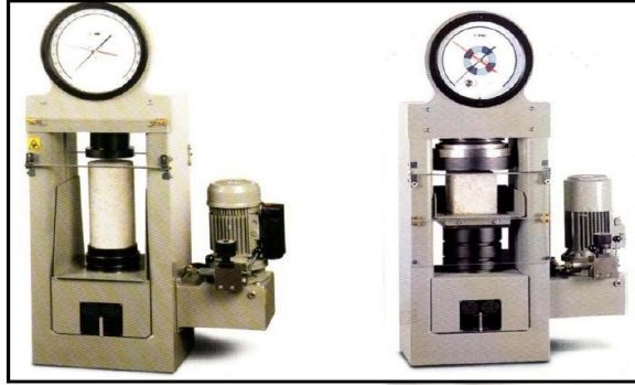
شىۋەي(8-18) دانانى نمونەى شەشپالو و لولەكەكان لە مەكىنەى فشاردا
