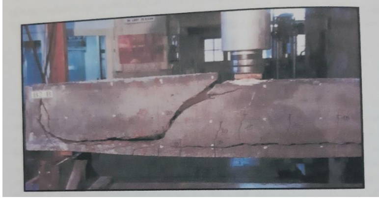
شېۋە(8-29) دارمانى برىن(توندىردى تىرەيى) لە جىسردا لە كۆنكرېتى شېشداردا
