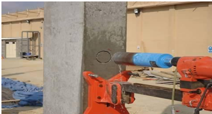
شىۋەي(9-16) ئامپىرى دلى كۆنكرېت Core و ۋەرگرتنى نمونەيەكى ناسۆيى لە دىۋار
