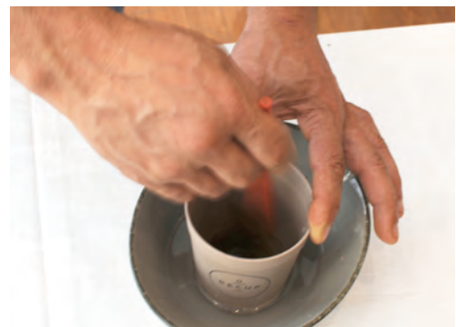
Abb. 1–4: Oud-Werkstatt im PopUp Raum. Mohamed Koudir mit Lautenmuschel und Formraster (oben links). – Vorbereitung der Materialien (oben rechts). – Knochenleim- und Schellackgranulat (unten links). – Anrühren des Leims im Wasserbad (unten rechts). Fotos: Oliver Wiener.
