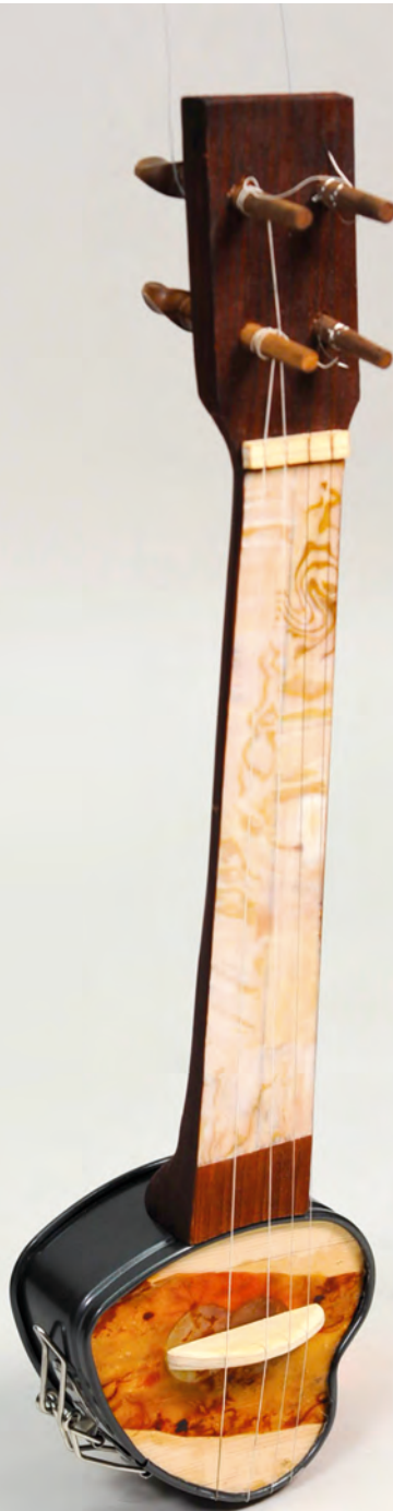
Abb. 5: Lernobjekt – kleine Laute mit Kuchenformresonator. Es handelt sich um ein Instrument, das von Teilnehmer:innen des Workshops am 18. Juni 2022 gebaut wurde. Foto: Oliver Wiener.
