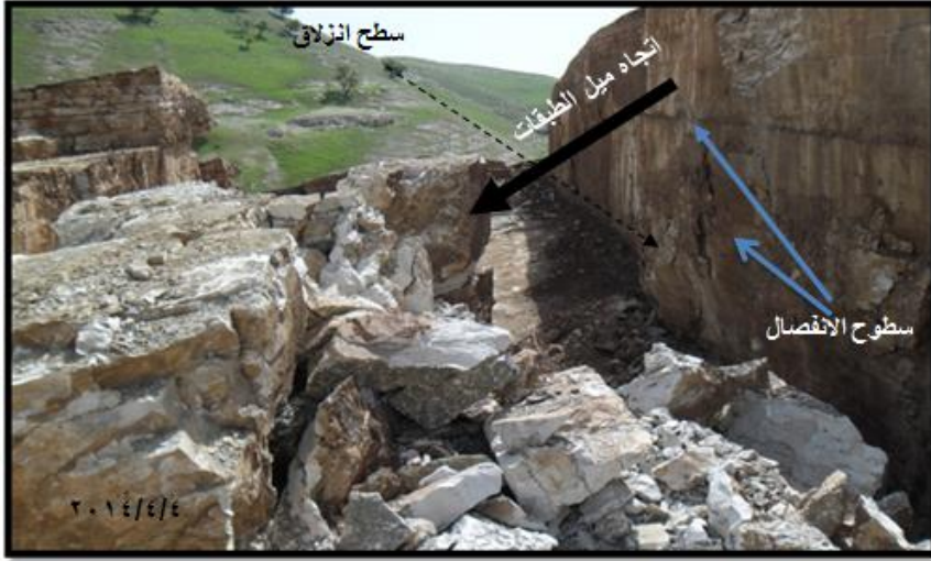
صورة رقم (3) تبيين سطح الانزلاق وميل الطبقات الصخرية.
